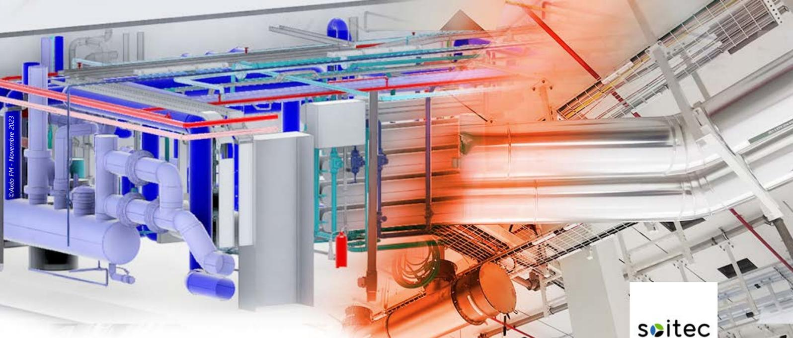
Au-delà du relevé photogrammétrique, ce projet nécessite le géoréférencement précis du bâtiment. Pour se faire, notre géomètre Axéo FM complète par un relevé topographique à la station totale pour caler les coordonnées GPS du site. De plus, nos BIM Modeleurs ont réalisé la modélisation d'un local technique de 60 m<sup>2</sup> (structure et réseaux) pour venir l'ajouter au modèle 3D existant.
